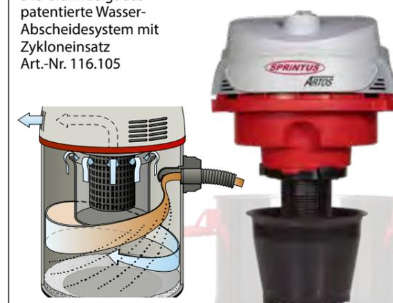
Durch den Drall am Einlaßstutzen wird der Sprühnebel an der Behälterwand abgeschieden. Zusätzliche Filterstoffe sind nicht mehr notwendig. Die zuverlässige Schwimmerabschaltung reagiert selbst bei extremer Schaumbildung. Seitliche Kühl-Luftschnitte sorgen für konsequente Trennung von Kühl- und Prozessluft.
