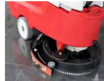
Saugbalken schwenkt automatisch in die Arbeitsrichtung.
