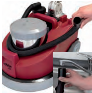
Frischwassertank kann mittels Stretschlauch direkt am Wasserhahn befüllt werden.
